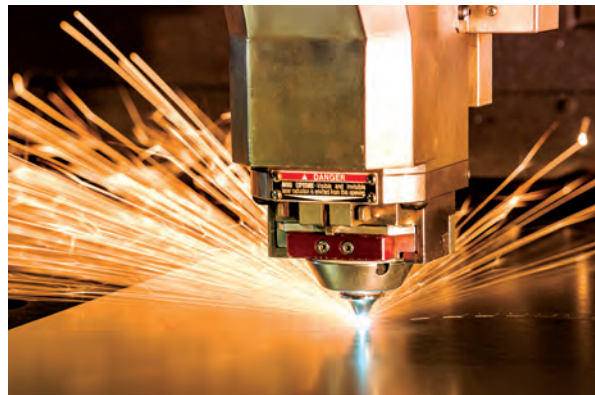
Mašina za lasersko sečenje obrađuje metal.
